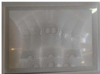
Lente di Fresnel impiegata per ottenere una maggiore copertura di sensing (coverage)
